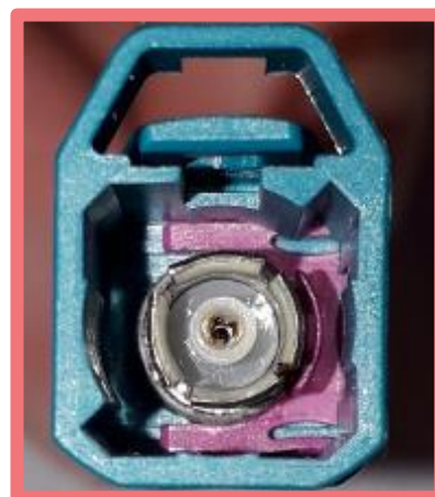
Beispiel: Beschädigung Koaxial-Steckerverbinder
